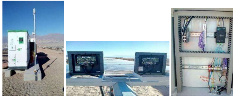
Figura 13. Celdas Calibradas (Soiling) y Estaciones Meteorológicas Referenciales
