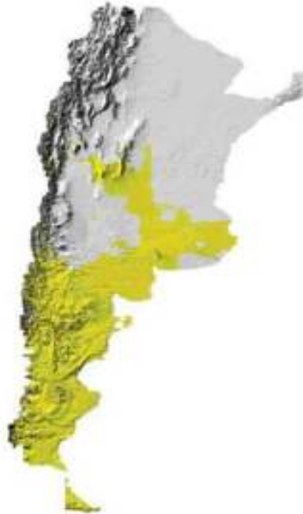
Figura 2. Factor de Capacidad >35% a 70m de altura.
